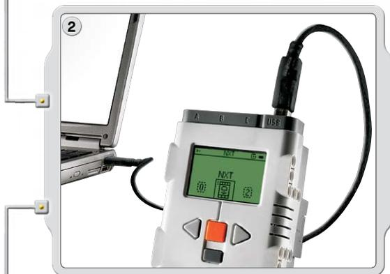
Verbinde PC und NXT mit dem USB-Kabel.
