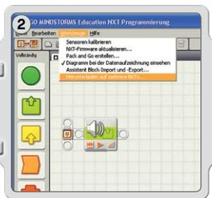
Wenn alle Programme, die du herunterladen willst, geöffnet sind, starte die Funktion mit der Option Herunterladen auf mehrere NXTs... im Werkzeug-Menü. Mit dieser Menüoption wird das Dialogfenster „Herunterladen auf mehrere NXTs“ geöffnet.
