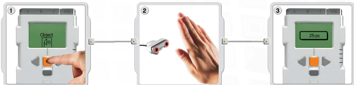
1 Wähle das Ultraschallsensor-Symbol aus. Wähle den Port aus, an den der Sensor angeschlossen ist.
