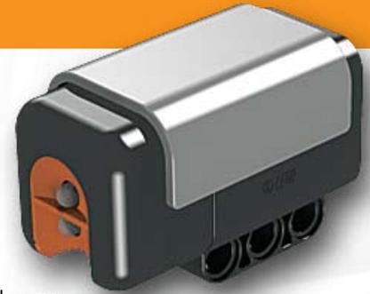
Mit dem Lichtsensor kann ein Roboter zwischen hell und dunkel unterscheiden, die Belichtungsintensität eines Raumes feststellen und die Lichtstärke farbiger Oberflächen messen.
