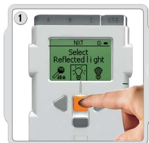
1 Wähle das Symbol des Sensors oder des Motors aus, der getestet werden soll. Bei jedem Testvorgang kannst du nur die Werte eines Sensors bzw. eines Motors auslesen.
