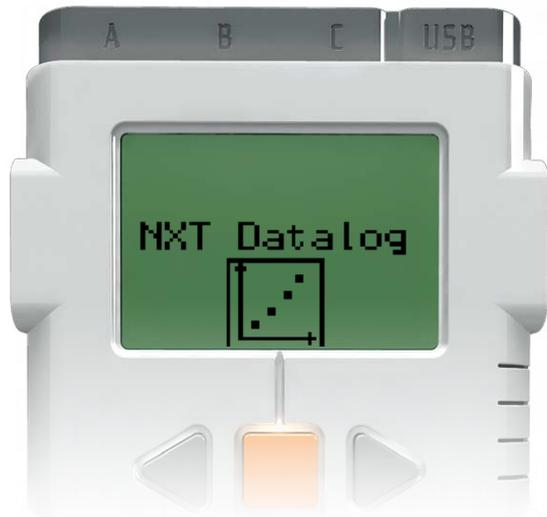
Im NXT-Messwerterfassungs-Untermenü [NXT Datalog] kannst du Messwerte erfassen, ohne mit deinem Computer verbunden zu sein.
