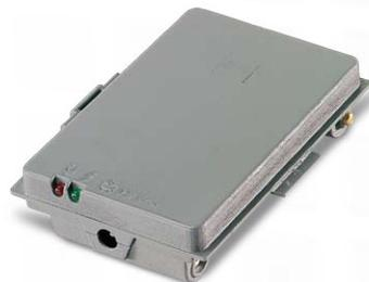
Schließe beim ersten Einsatz des Akkus im NXT den Transformator an und lade den Akku im NXT ca. 20 Minuten auf, bevor du den NXT verwendest. Dies solltest du auch dann machen, wenn der Akku vollständig entladen wurde.
