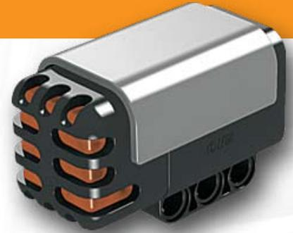
Der Geräuschsensor erkennt den Geräuschpegel, d. h. wie leise oder laut ein Geräusch ist. Die Erkennung durch den Geräuschsensor kann sowohl in dB als auch in dBA erfolgen.
