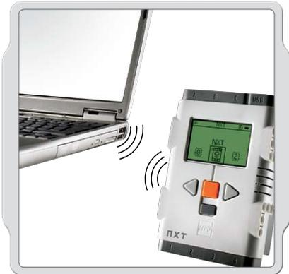
Bluetooth ist eine Kommunikationstechnologie, mit der ohne übertragende Leitungen Daten gesendet oder empfangen werden können.
