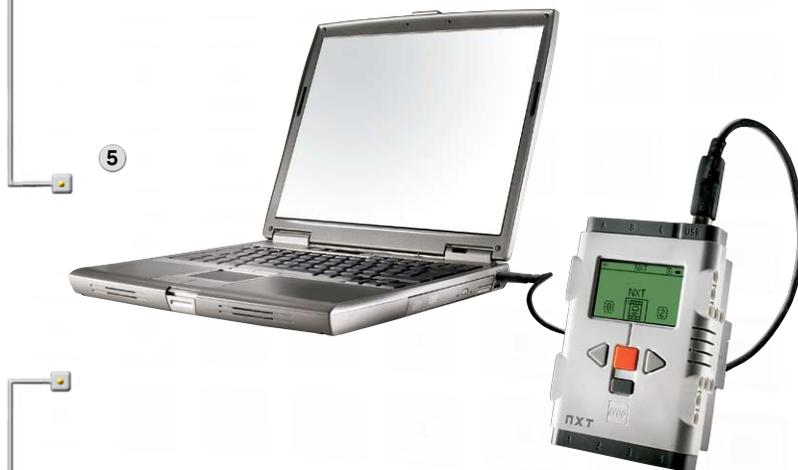
Stelle zunächst sicher, dass dein NXT eingeschaltet und über ein USB-Kabel mit deinem Computer verbunden ist (siehe Seite 9, Verbindungen der NXT-Technik).
