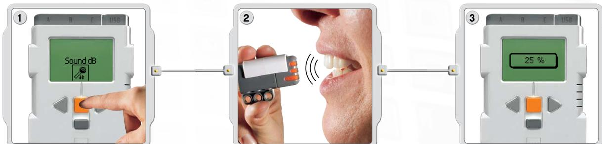
Wähle in der Anzeige des NXT-Displays View [Anzeige] aus. Wähle das Sound dB-Symbol aus. Wähle Port 2 aus.
