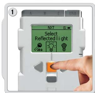
Wähle das Symbol „Reflected Light“ aus. Wähle den Port aus, an den der Sensor angeschlossen ist.
