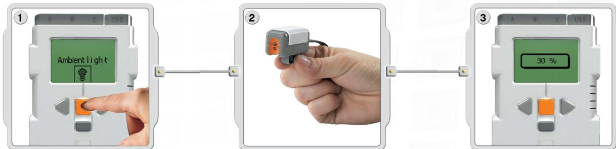
Wähle das Symbol „Ambient Light“ [Umgebungsbelichtung] aus. Wähle den Port aus, an den der Sensor angeschlossen ist.
