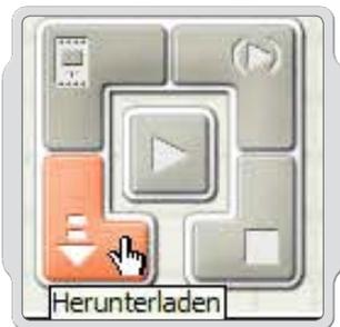
Wenn das Programm fertiggestellt ist, kann es auf den NXT heruntergeladen werden. Achte darauf, dass du vor dem Herunterladen den NXT anschaltest und mit dem Computer verbindest.
