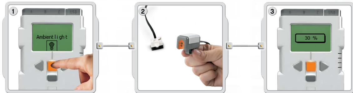
1 Setze die Lampen zur Aktivierung des Lichtsensors ein. Wähle die Option „Ambient Light“ [Umgebungsbelichtung] aus.
